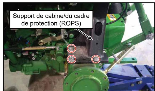
4. Retirez les deux boulons du support de chargeuse gauche comme illustré. Mettez les boulons de côté.
