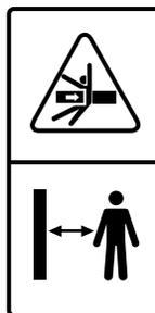
**Risque de blessure par collision avec les fourches de la pince lors du verrouillage ou du déverrouillage du pivot. Le pivot de la fourche de la pince est soumis à la tension d'un ressort et, lorsqu'il est déverrouillé, il peut faire tourner la pince avec une force inattendue.**
