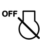
**ARRÊT** Pour couper l'alimentation en électricité et arrêter le moteur, tournez la clé jusqu'au bout dans le sens contraire des aiguilles d'une montre.
