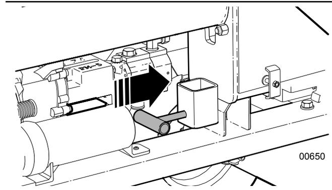
Fig. 31 – Goupille de sécurité complètement enclenchée
