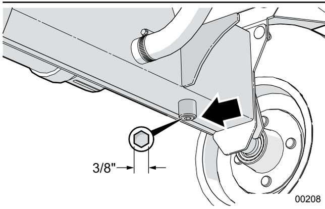
Fig. 35–Bouchon de vidange du réservoir d'huile hydraulique
