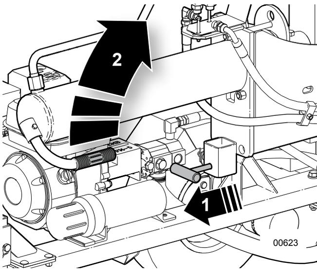
Fig. 28 – Tourner la fendeuse en position verticale
