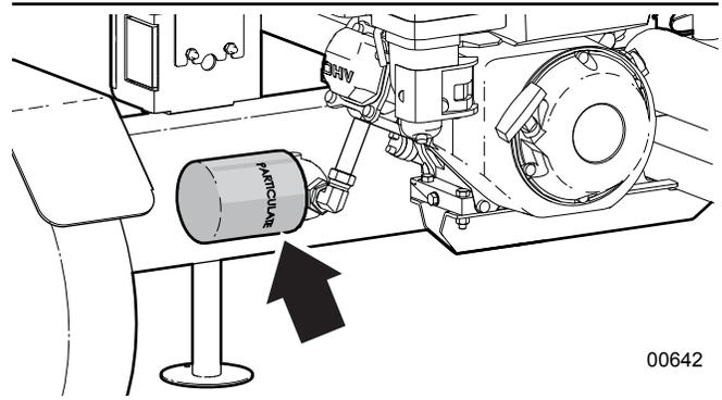
Fig. 36–Filtre à huile hydraulique
