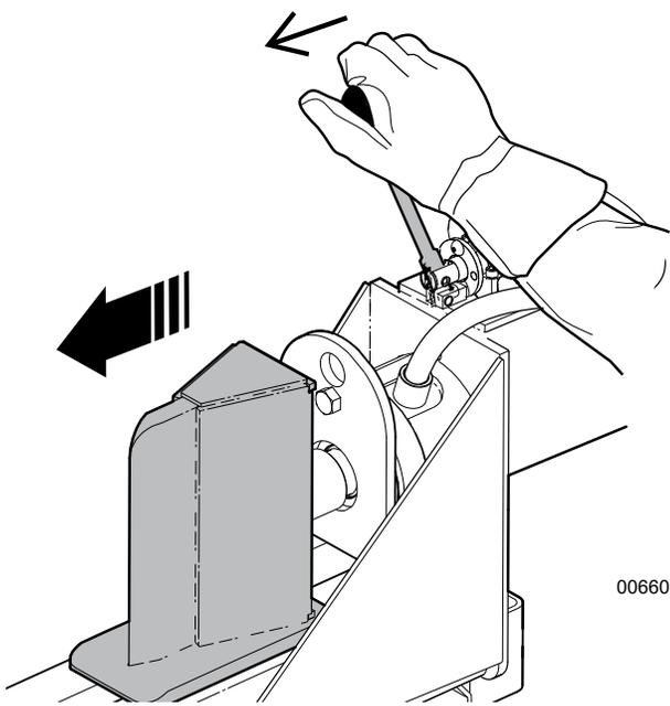
Fig. 12 – Déploiement du coin pour fendre le bois
