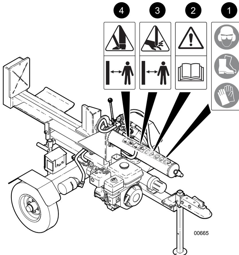
Fig. 2 – Emplacement des autocollants de sécurité (typique pour les modèles de série WX500)
