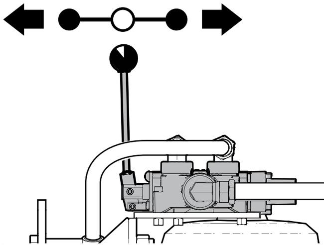
Fig. 25 – Positions de la soupape de commande hydraulique
