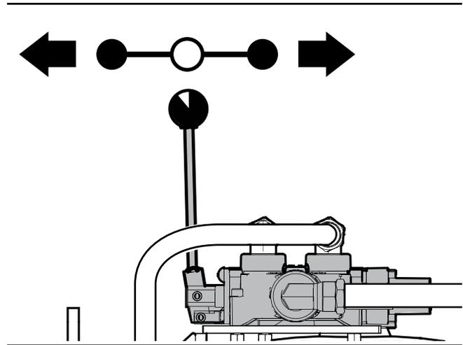
Fig. 10 – Soupape de commande de la fendeuse
