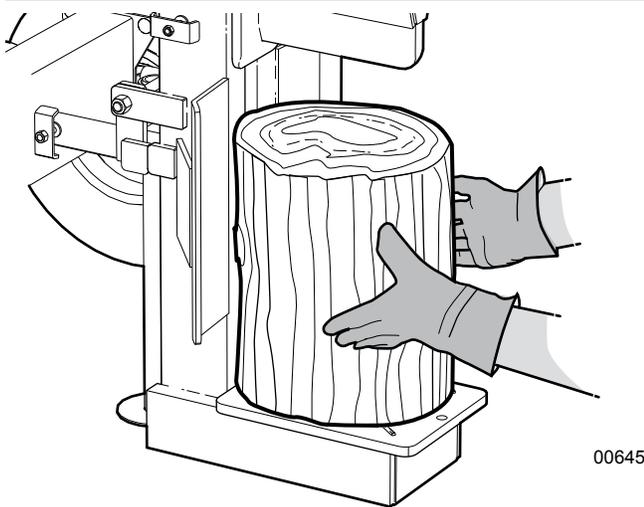
Fig. 29 – Bon positionnement des billes— vertical
