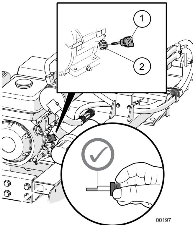
Fig. 15 – Vérification du niveau d'huile moteur
