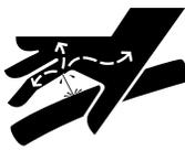
3. Ne tentez pas de faire de réparations improvisées sur les conduites ou raccords hydrauliques à l'aide de ruban, de pinces ou d'adhésifs. Le système hydraulique fonctionne sous une pression extrêmement élevée. De telles réparations peuvent céder de façon subite et causer une situation dangereuse.
