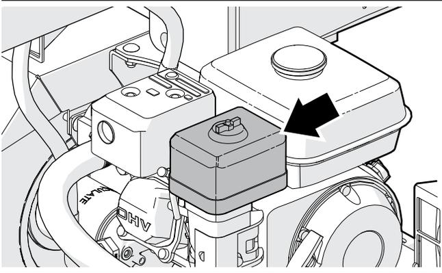
Fig. 37 – Filtre à air du moteur
