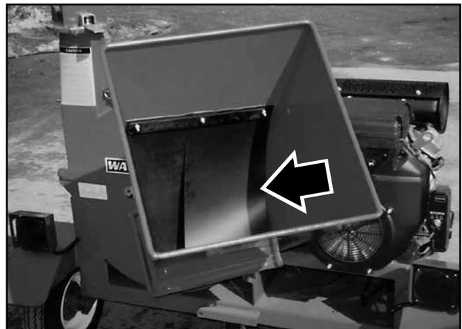
Fig. 22 – Rideau de sécurité dans la trémie d'alimentation
