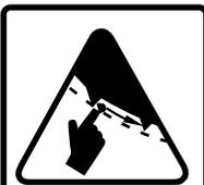
Ne mettez jamais les mains dans la trémie d'alimentation lorsque le broyeur est en fonctionnement. Vous risqueriez de toucher aux couteaux sur le rotor, ce qui peut causer des lésions graves.
