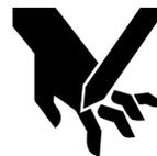
**Risque de pincement ou d'écrasement! Ne jamais mettre le bras dans le lit de fendage pour repositionner une bille. Utiliser plutôt un tourne-bille (crochet à bois) ou un autre outil.**
