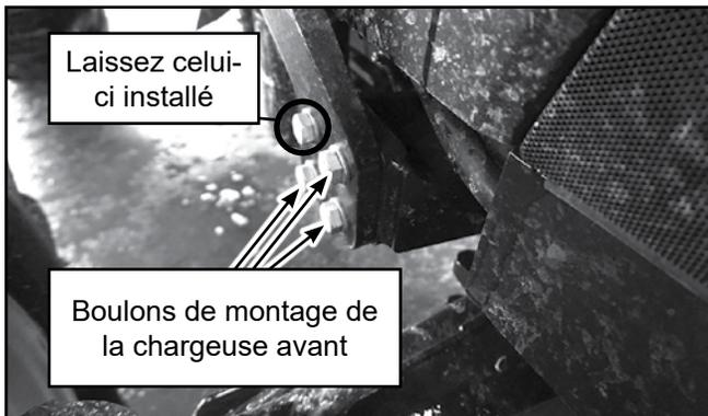
6. Assemblez le rail de charge gauche (9) (3652L308) avec un support de la chargeuse (11) (3652L309). Utilisez des gros boulons à tête hexagonale 1/2 po NC x 2 po (15) (Z71520), des rondelles 1/2 po (21) (Z73151) et des contre-écrous 1/2 po NC (19) (Z72251). **Serrez seulement à la main pour l'instant.**
