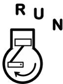
**MARCHE** Tournez dans le sens horaire jusqu'à la détente centrale pour se placer sur la position de marche. C'est la position sur laquelle le moteur continue de fonctionner.
