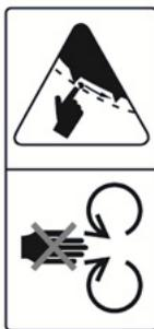
**Attention** : N'essayez jamais d'atteindre la trémie d'alimentation; utilisez plutôt un bâton ou une branche afin de pousser tout morceau coincé dans les rouleaux. Si le bourrage persiste, arrêtez le moteur et attendez que le rotor s'arrête avant de dégager le bourrage.
