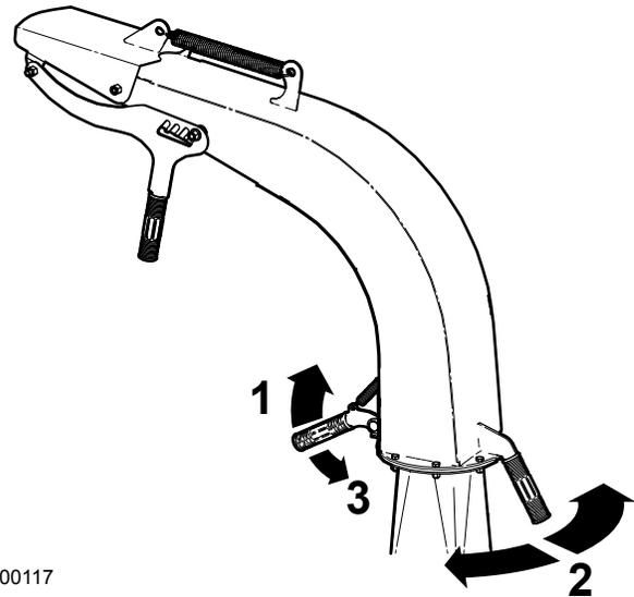
Fig. 11—Discharge Chute
