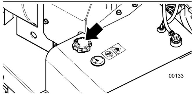
Fig. 31—Fuel tank Cap
