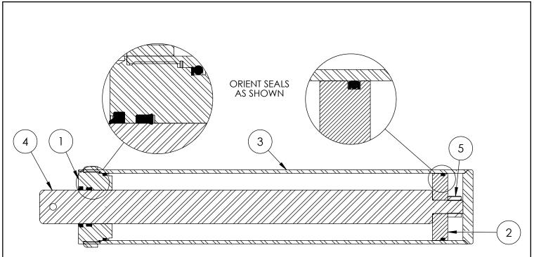
**5" x 24" STROKE CYLINDER PARTS**
