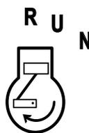
**RUN (ON)** – Tournez dans le sens horaire jusqu'à la détente centrale pour se placer sur la position de marche. C'est la position sur laquelle le moteur fonctionne. Pendant une tentative de démarrage, arrêtez-vous brièvement sur la position RUN pour mettre en marche les systèmes électroniques.
