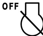
**OFF** – Pour couper l'alimentation en électricité et arrêter le moteur, tournez la clé jusqu'au bout dans le sens contraire des aiguilles d'une montre.
