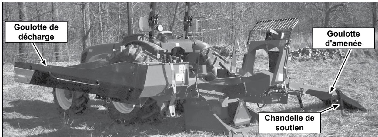
13. Finalement, ajustez la goulotte de décharge selon la hauteur nécessaire, déployez les chandelles de soutien de sorte qu'elles reposent solidement sur le sol, et assurez-vous que la lèvre frontale de la goulotte d'amenée est contre le sol (pour éviter de bloquer le mouvement des billes). Si cela est nécessaire, ajustez l'attelage en trois points de façon à ce que la goulotte d'amenée soit positionnée de niveau et que les chandelles de soutien aient une bonne prise sur le sol.
