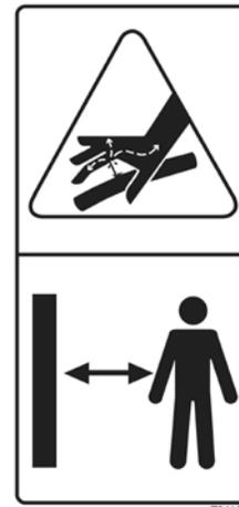
**Faites toujours preuve de prudence en travaillant avec un système hydraulique sous haute pression.**
