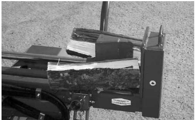
**Fig. 17 HORIZONTAL SPLITTING**
