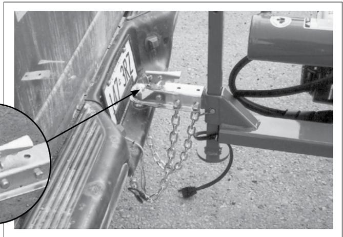
Fig. 29 RETAINER/STAND/SAFETY CHAIN
