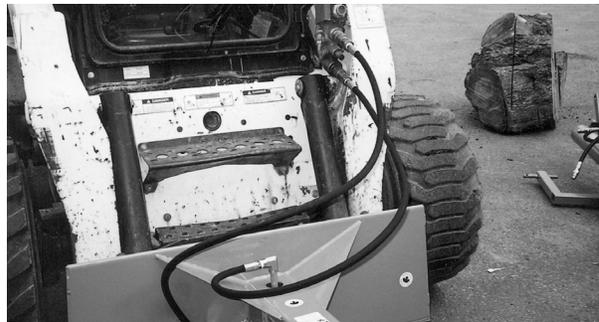
**Positionnez les tuyaux hydrauliques de façon sécuritaire.**
