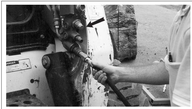
Fig. 1 SORTIES HYDRAULIQUES (typique)
