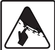
Ne touchez jamais la trémie d'alimentation lorsque la déchiqueteuse est en marche. Cela risque d'entrer en contact avec les couteaux du rotor et de provoquer des blessures graves.
