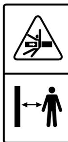
Risque de blessure par collision avec les fourches de la pince lors du verrouillage ou du déverrouillage du pivot. Le pivot de la fourche de la pince est soumis à la tension d'un ressort et, lorsqu'il est déverrouillé, il peut faire tourner la pince avec une force inattendue.
