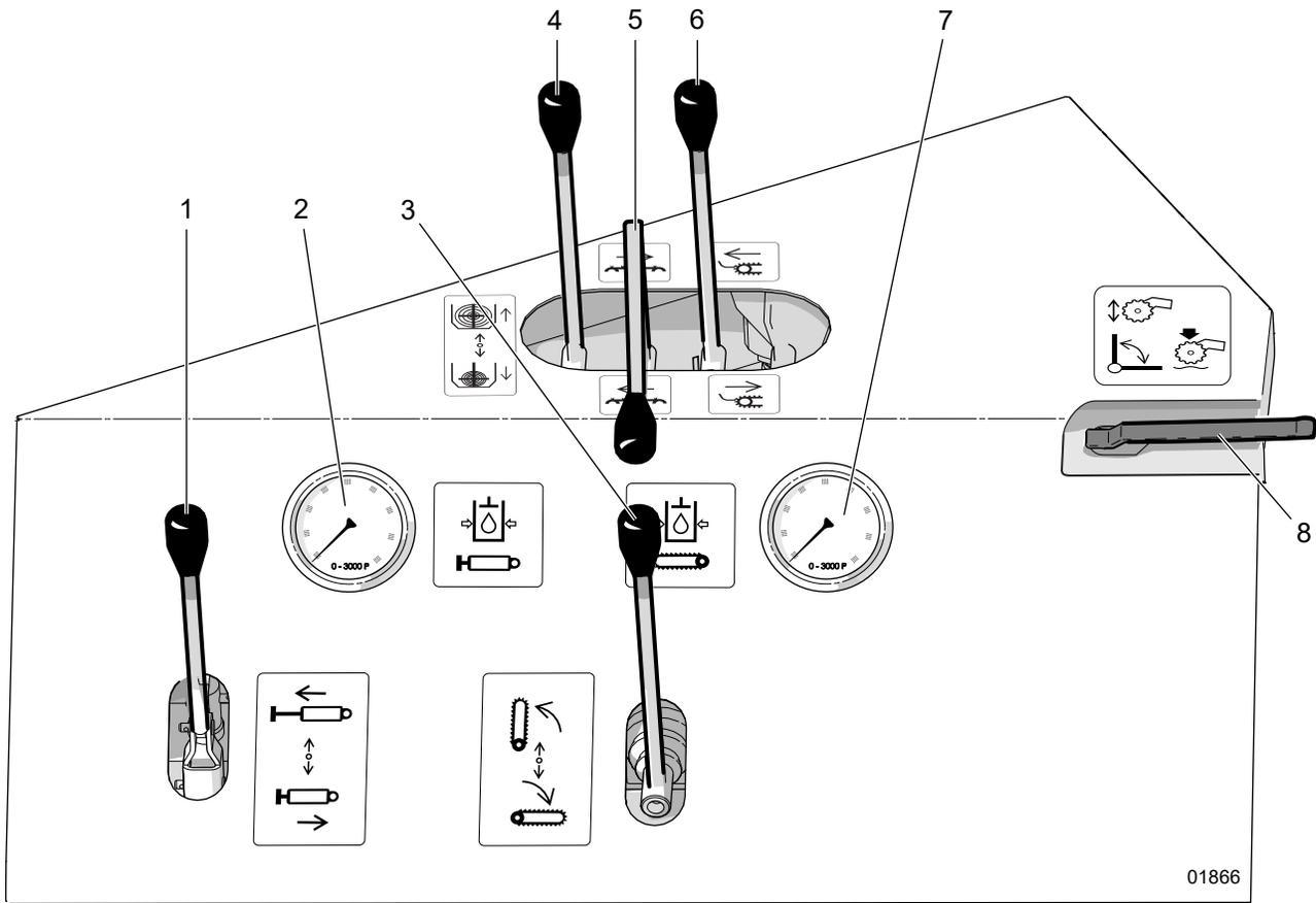
Fig. 20—Hydraulic Controls
