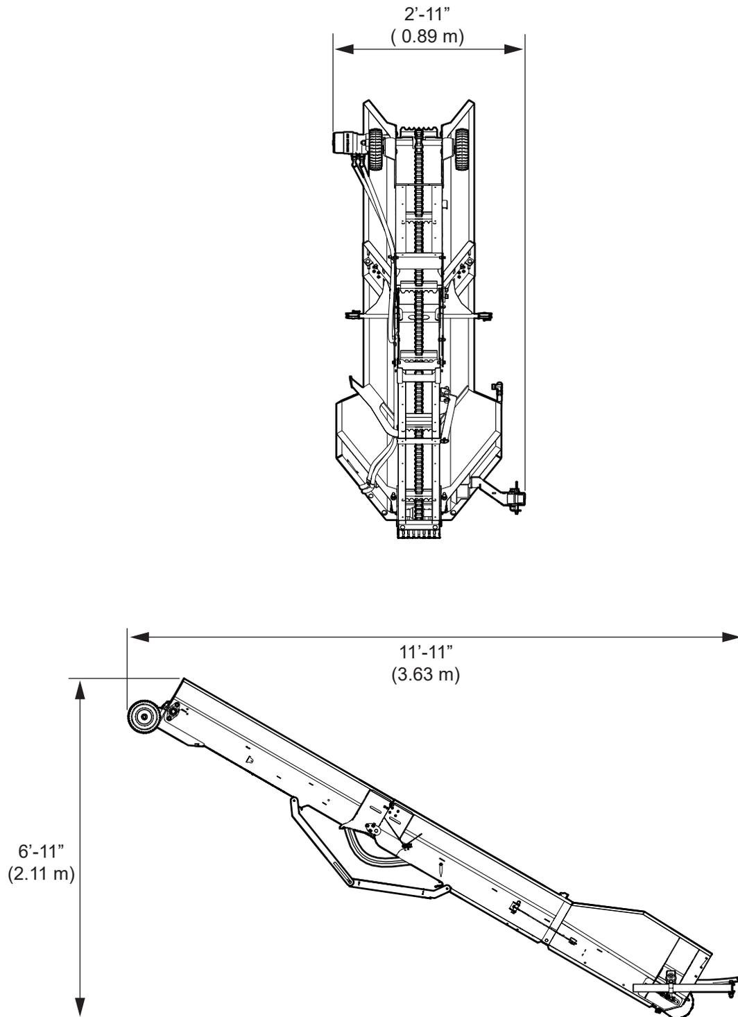
Fig. 102—12 ft Conveyor Dimensions
