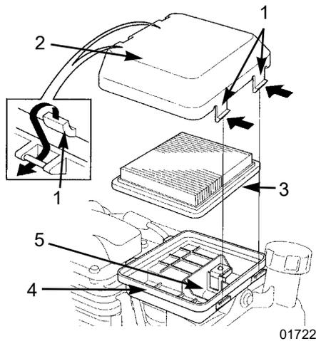
Fig. 27 – Filtre à air du moteur
