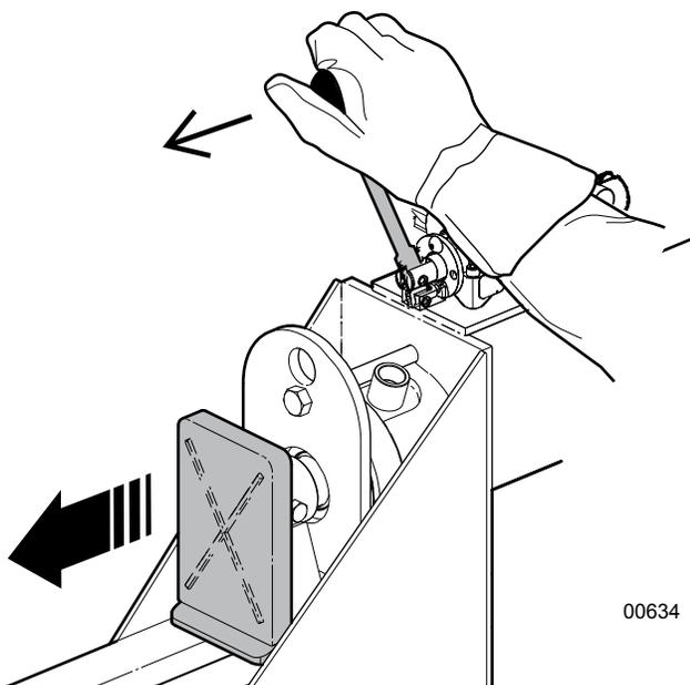
Fig. 10 – Déploiement du bloc de poussée pour fendre le bois
