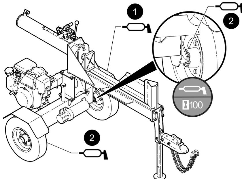
Fig. 24—Points de graissage
