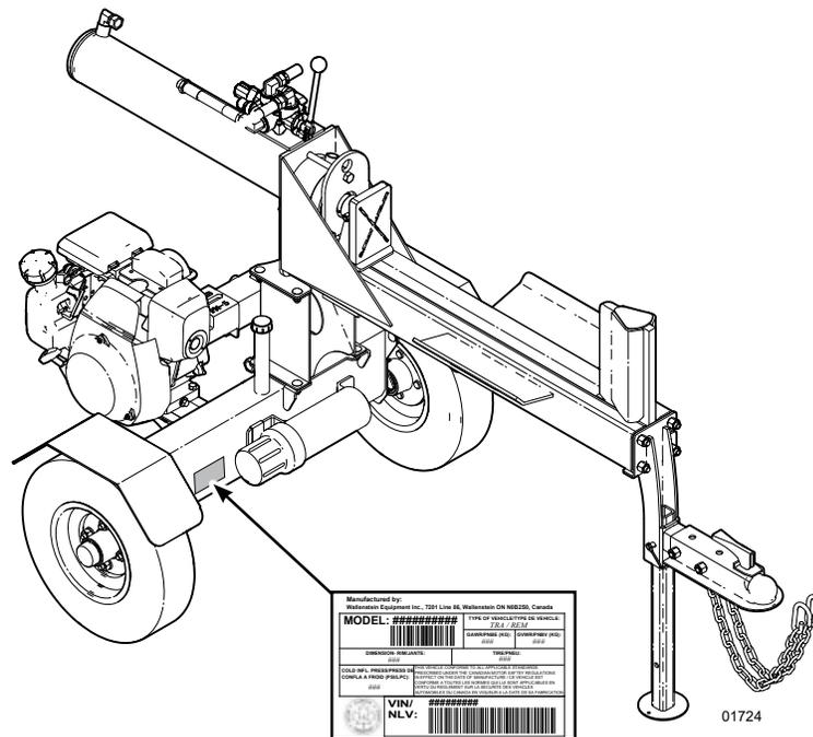
Fig. 1 – Emplacement des autocollants de sécurité (typique pour les modèles)
