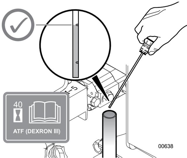
Fig. 13 – Jauge graduée de vérification du niveau d'huile hydraulique
