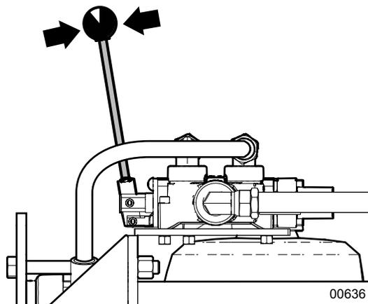
Fig. 9 – Position Neutre (centrale)
