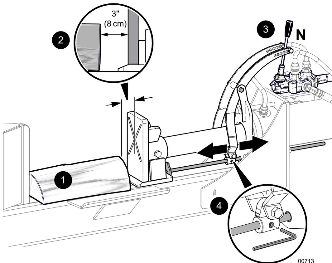
Fig. 23—Ajustement du limiteur de course
