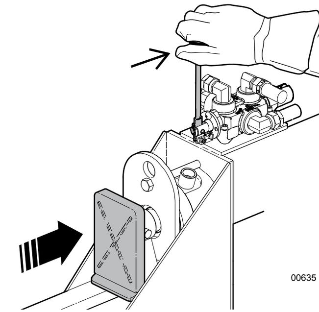
Fig. 11 – Rentrée du bloc de poussée
