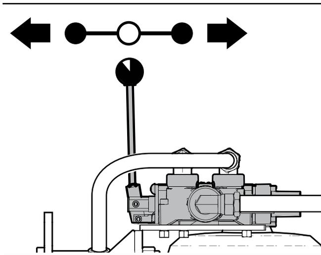
Fig. 21 – Positions de la soupape de commande hydraulique
