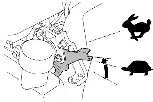
Fig. 17 – Commande des gaz du moteur
