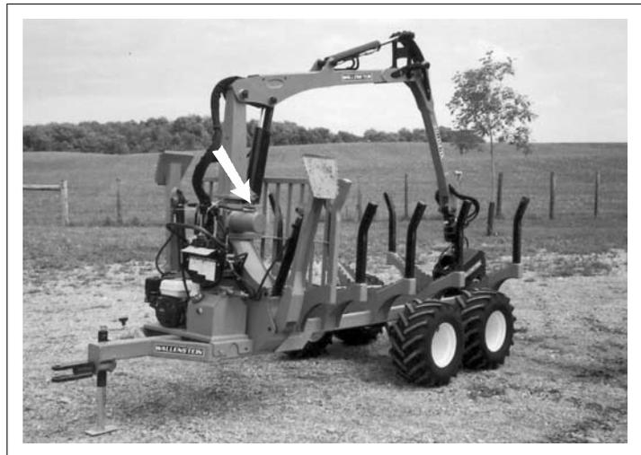
**Fig. 18 BOOM SWING LOCK PIN**
