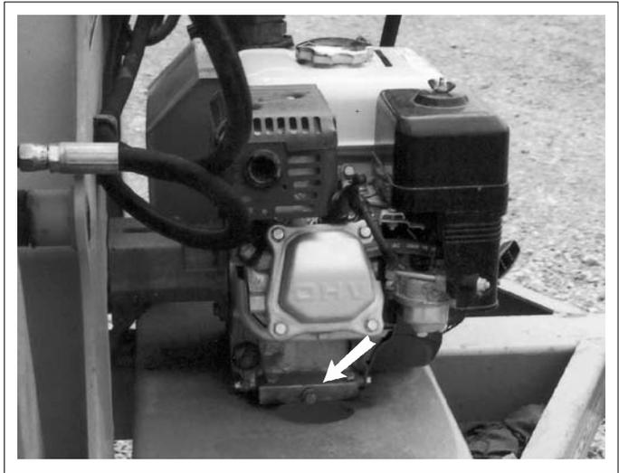
**Fig. 25 DRAIN PLUG**
