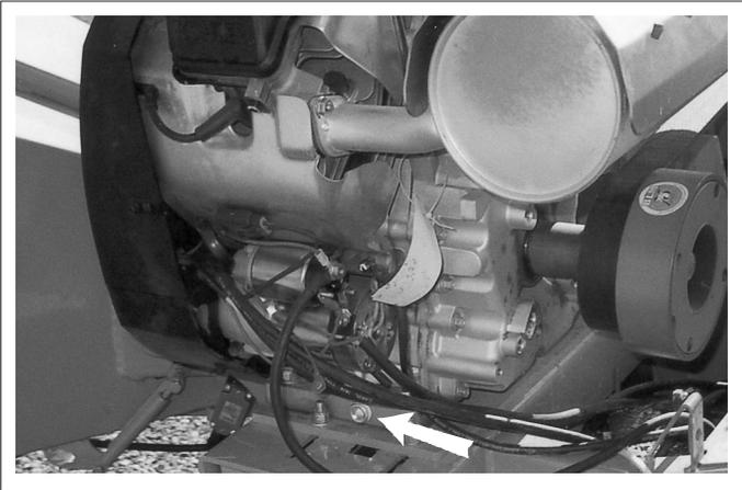
**Fig. 42 DRAIN PLUG**
