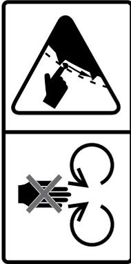
Ne mettez jamais les mains dans la trémie d'alimentation lorsque le broyeur est en fonctionnement. Vous risqueriez de toucher aux couteaux sur le rotor, ce qui peut causer des lésions graves.
