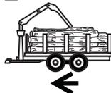
Tirez la manette vers l'arrière pour déplacer l'essieu vers l'avant sur le châssis de la remorque.
