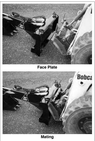
Fig. 4 ALIGNING
