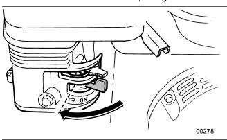
Fig. 28-Fuel Valve OFF
