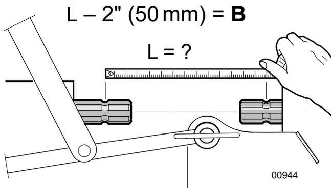
Fig. 9—Measurement B
