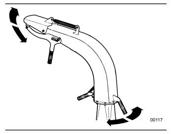
Fig. 37 - Discharge Chute
