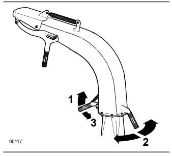
Fig. 11 - Discharge Chute
