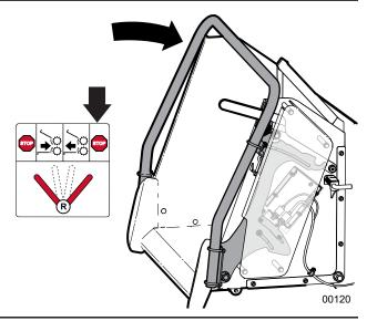
Fig. 14-Forward STOP position
