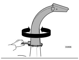
Fig. 22 - Discharge Chute
