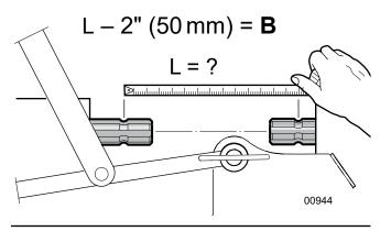
Fig. 17 - Measurement B
