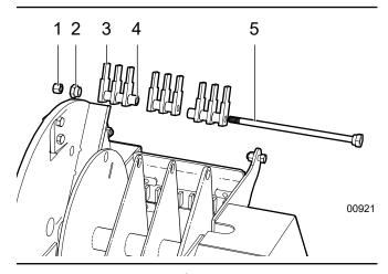
Fig. 50 - Shredder Knives
