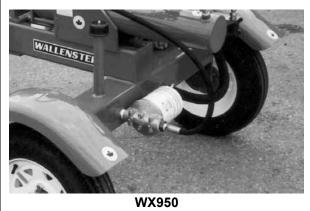
Fig. 34 HYDRAULIC SYSTEM FILTER
