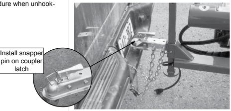
Fig. 29 RETAINER/STAND/SAFETY CHAIN
