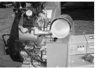
a. Drain Plug b. Fill Plug c. Dip Stick
