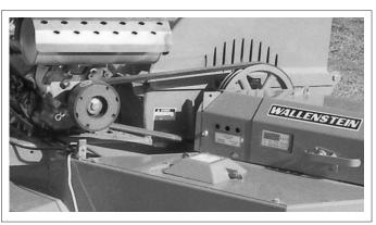
Fig. 39 ROTOR DRIVE SYSTEM
