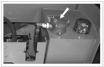
Fig. 49 HYDRAULIC FILTER
