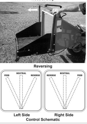
Fig. 3 HYDRAULIC FEED CONTROL LEVER
