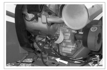
Fig. 42 DRAIN PLUG
