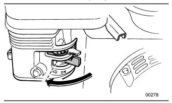
Fig. 25-Fuel Valve OFF
