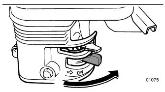
Fig. 19-Fuel Valve Lever
