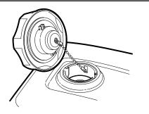
Fig. 14-Fuel Filler Cap
