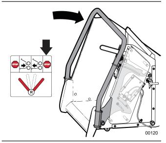
Fig. 14-Forward STOP position
