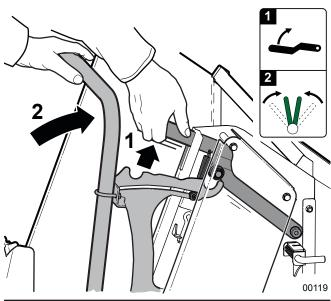
Fig. 16-Detent Reset Lever
