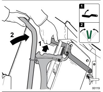
Fig. 38-Detent Reset Lever
