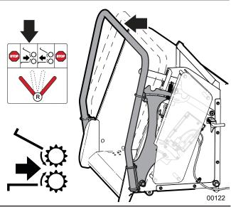
Fig. 39-Forward Feed Position
