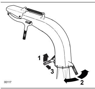
Fig. 11 – Discharge Chute
