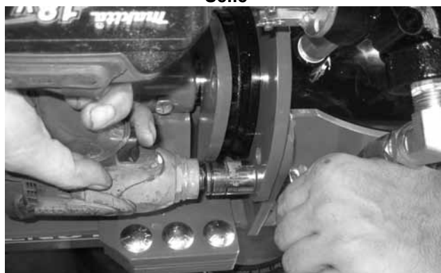
Fixation de la selle sur le vérin
