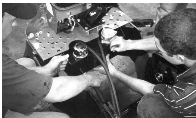
Fig. 5 – Installation du réservoir dans le cadre de la pelle rétrocaveuse
