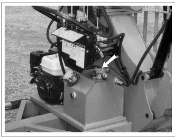
Fig. 26 HYDRAULIC SYSTEM OIL FILTER
