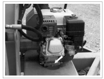
Fig. 25 DRAIN PLUG
