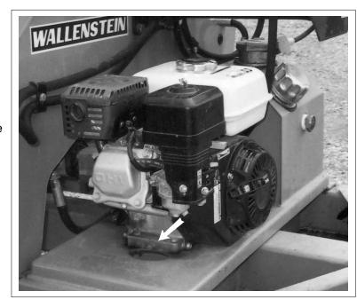
Fig. 31 ENGINE OIL - DRAIN PLUG
