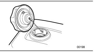
Fig. 17-Fuel Filler Cap
