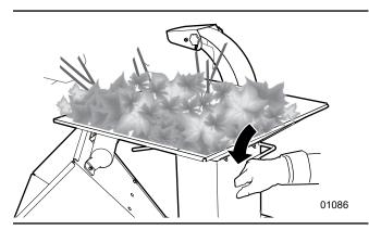
Fig. 28-Shredder Feed Control Handle
