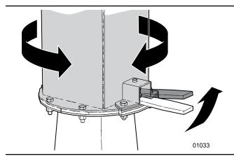
Fig. 13-Discharge Chute Rotation
