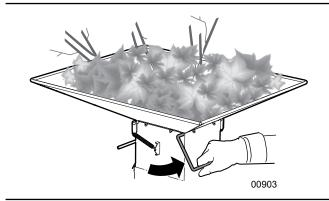
Fig. 21-Shredder Feed Control Handles
