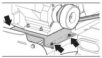
Fig. 33-Engine Mount Bolts
