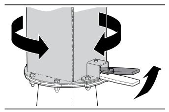
Fig. 13-Discharge Chute Rotation
