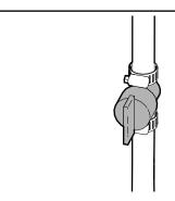
Fig. 18-Fuel Valve Open
