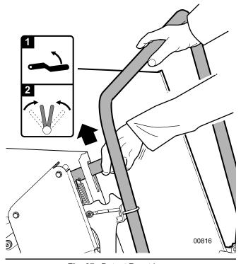
Fig. 27 - Detent Reset Lever
