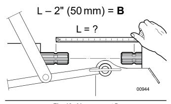
Fig. 18-Measurement B
