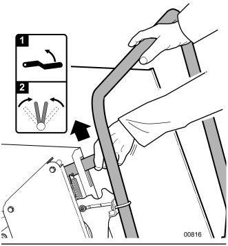
Fig. 53 - Detent Reset Lever
