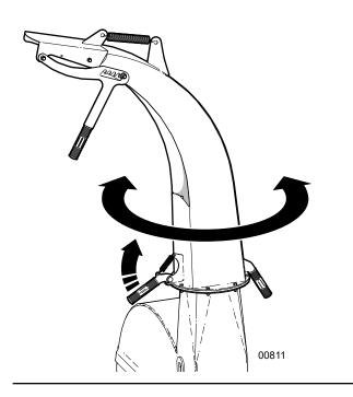
Fig. 24-Discharge Chute
