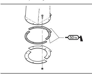
Fig. 27 - Discharge Chute
