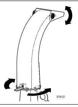
Fig. 14-Adjust Discharge Chute.
