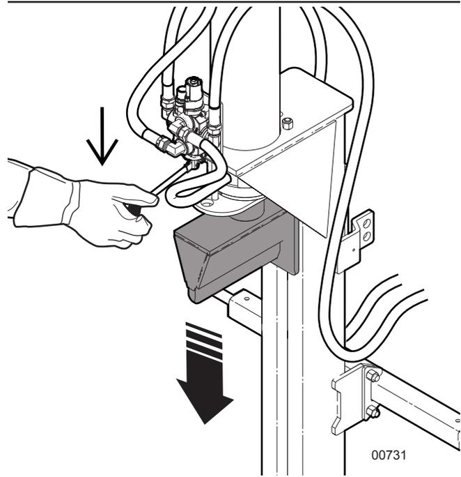
Fig. 5 – Déploiement du coin pour fendre le bois
