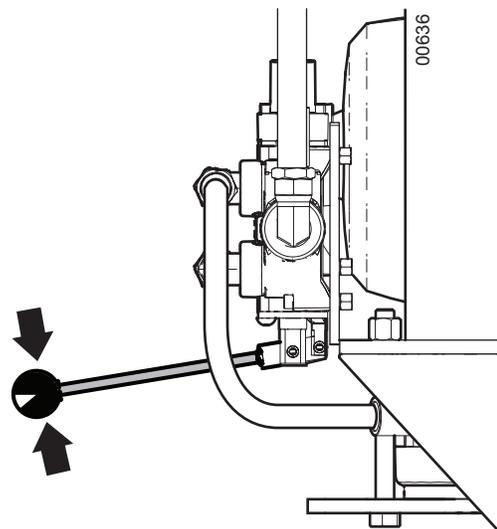
Fig. 6 – Position Neutre (centrale)
