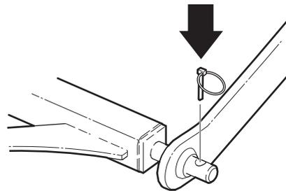
Fig. 10 – Fixez les bras de relevage et les esses
