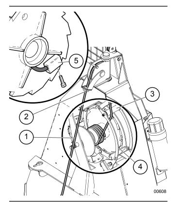
Fig. 53-Installing Rope
