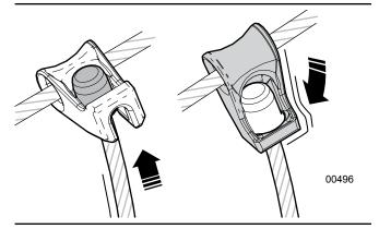
Fig. 24-Forged Cable End
