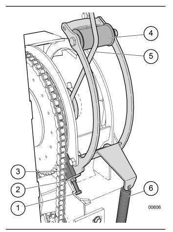
Fig. 51 – Winch Brake
